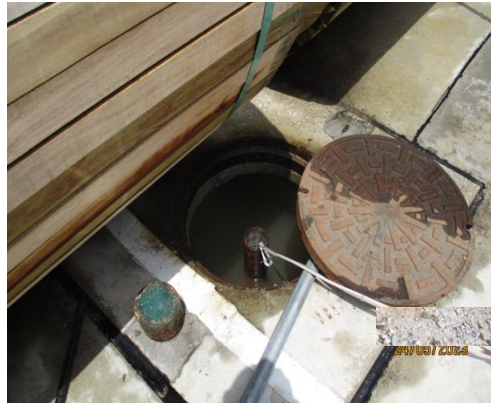
บ่อสังเกตการณ์น้ำใต้ดินท้ายน้ำ ของโครงการโรงผลิตสารโอเลฟินส์ โรงที่ 1/2 (MW02)
